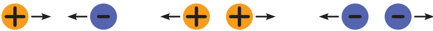
ပုံ (၃-၆) လျှပ်စစ်ဓာတ်ဖိုများနှင့် လျှပ်စစ်ဓာတ်မများအကြား ဖြစ်ပေါ်သောအားအမျိုးမျိုး
